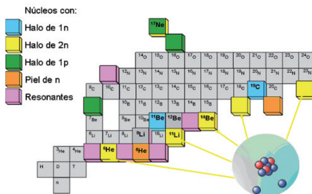
Figura 5. Vista parcial de la carta de nucleidos en la que se identifican mediante un código de colores los núcleos estudiados hasta la fecha que presentan estructuras de halo neutrónico, en azul (1n) y amarillo (2n), halo protónico en verde y piel neutrónica en naranja, así como los núcleos resonantes en malva, cuya caracterización permite entender como se forma el halo de dos neutrones.
